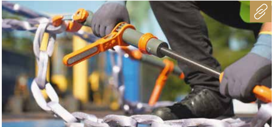
Gegenüber einem Standard-Ratschlastspanner verfügt der neue DoQuick über einen doppelt so langen Spannweg. Das Einhängen der Ketten ist dadurch weniger anstrengend. Bild: Dolezych
