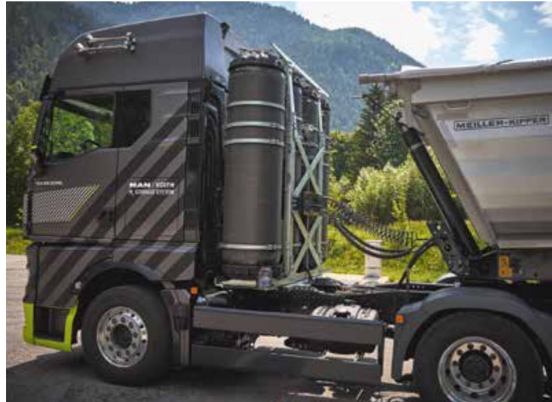
Bei den Testfahrten in Österreich zeigte MAN den Prototypen eines Wasserstoff-Verbrenner-Lkw, der als MAN hTGX in Kleinserie von 200 Fahrzeugen ab 2025 erstmals an Kunden ausgeliefert wird. Bild: MAN
