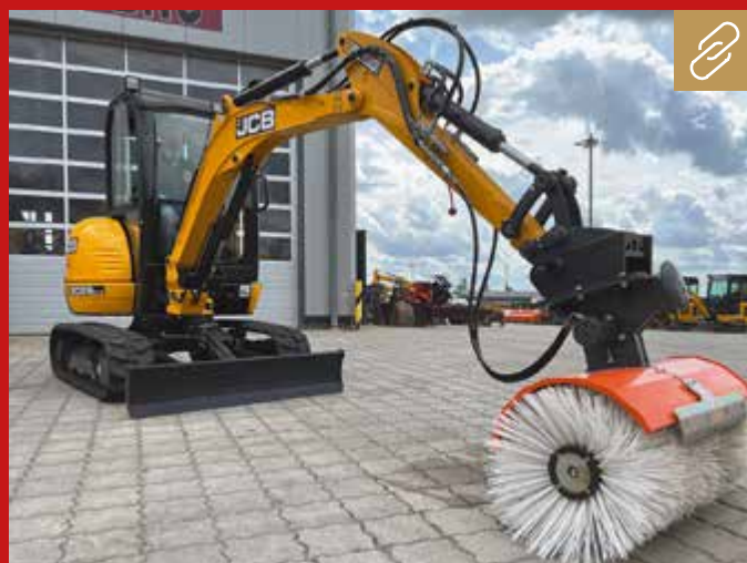
Bild rechts: Die Anbaukehrmaschinen KM 520 und KM 750 machen es möglich, Material heranzuschaffen oder Erd- und Profilarbeiten durchzuführen. Nach Arbeitsende sorgen sie dafür, dass die Baustelle sauber verlassen wird.
