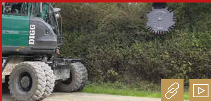
Die Wall- und Heckenschere CutWheel sorgt dafür, dass Hubsteiger bei der Pflege von Lichtraumprofilen, hohen Hecken und Waldrändern kaum mehr benötigt werden. Bild: Holp
