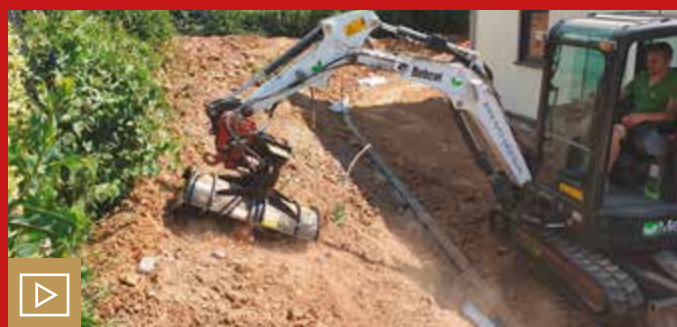
Mit den DMS-Anbaufräsen können der Boden aufgelockert und bepflanzungsfertige Flächen hergestellt werden – auch in schwer zugänglichen und steilen Bereichen. Bild: DMS
